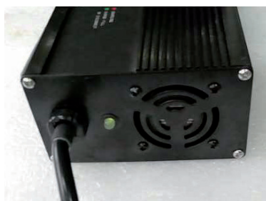
Figura 13 - ricarica batteria completa
